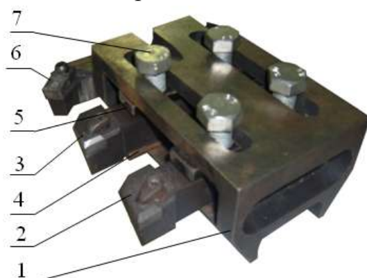
Рис. 8. Багаторізецевий тримач (пат. України № 24139): 1- тримач; 2, 3 - різець; 4 - прокладка; 5 - планка; 6 - базовий різець; 7 - болт
