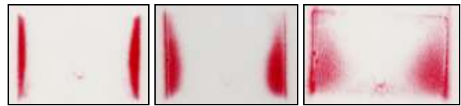
Рис. 28. Приклади контактних відбитків при зменшенні жорсткості пружного шару в 2 і 4 рази (від базової зліва направо)
