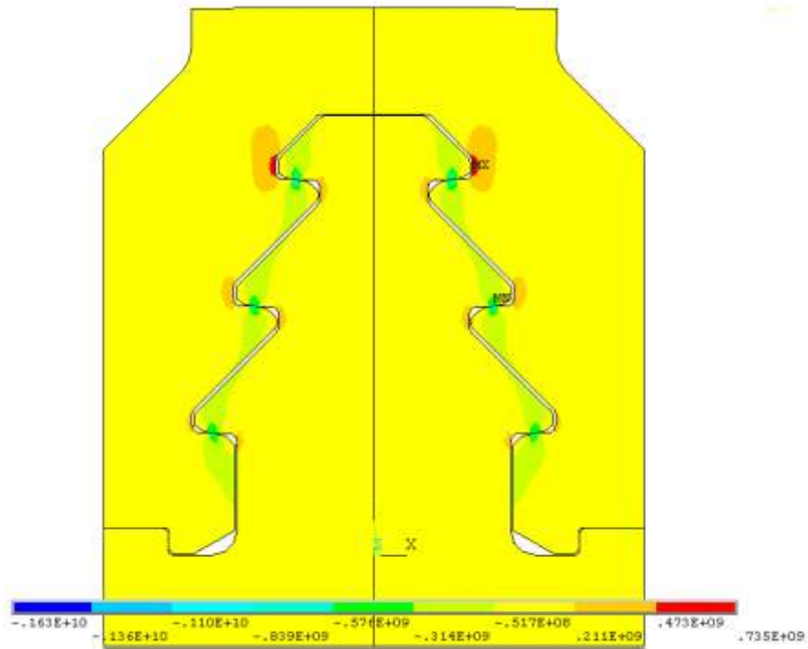
Рис. 10. Розподіл напруг у моделі з контактом на верхній парі опор
