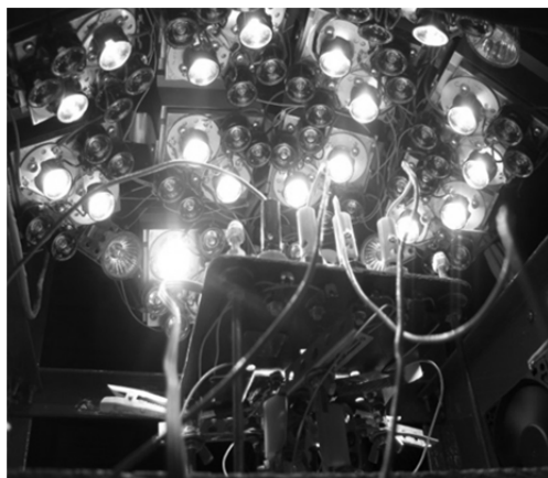
Рис. 1. Вигляд випромінювача універсального світлодіодно-галогенового освітлювача з боку джерел випромінювання (темні ділянки відповідають позиціям інфрачервоних світлодіодів з лінзами)
