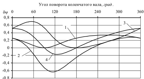
Рис. 2. Зависимости относительного углового перемещения кулисы  $\delta\psi$  от угла поворота базового кривошипа  $\phi_0$  при различных сочетаниях относительных погрешностей:
