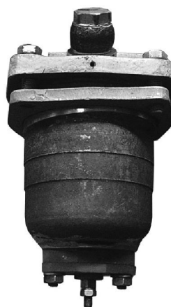
Рис. 3. Лабораторный вариант фильтра грубой очистки топлива с устройством подогрева.
