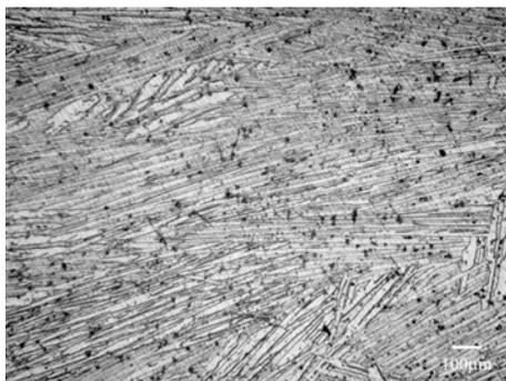
Рис. 3. Структура сплава Terfenol-D после термической обработки  $T=900^{\circ}\text{C}$ ,  $\tau=4$  часа
