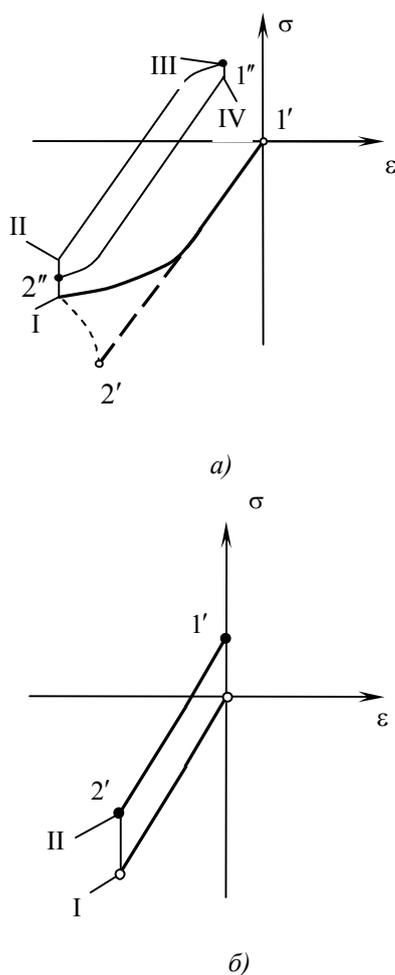
Рис. 5. Кривые деформирования поршня из алюминиевого сплава в определяющем ресурсную прочность цикле нагружения
