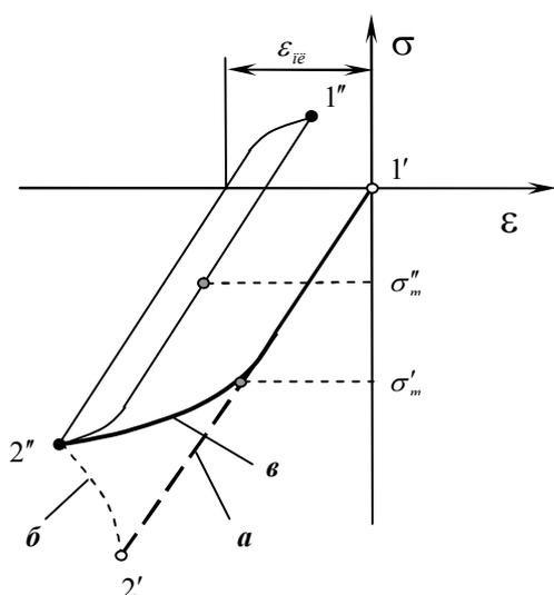
Рис. 1. Упруго-пластическое деформирование материала в особо нагруженной зоне КС
