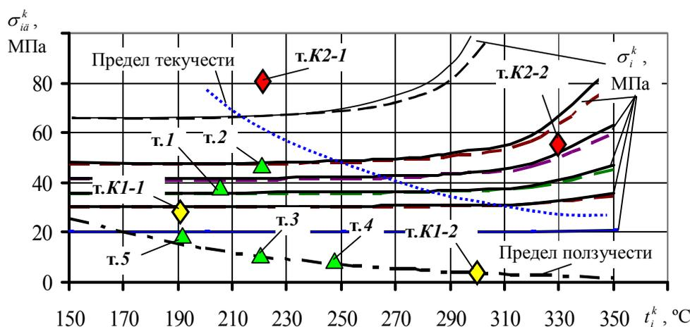
Рис. 4. Максимальные значения упругих напряжений  $\sigma_i^k$  для рассмотренных зон КС тонкостенного поршня бензинового ДВС (т.1-5) и зоны кромки открытой КС (т.К1-1, т.К1-2) и КС типа ЦНИДИ (т.К2-1, т.К2-2) дизеля
