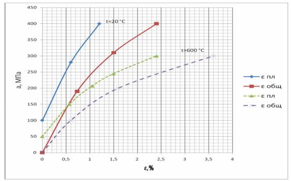
Рис. 1. Соотношение упругой и пластической деформации при растяжении алюминиевого ЧВГ в условиях разных температур ( $\varepsilon_{oбш} = \varepsilon_{nn} + \varepsilon_{ynp}$ )
