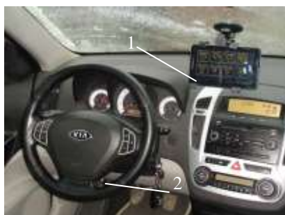
Рис. 3. Розміщення діагностичного комплексу в салоні ТЗ: 1 - планшет – монітор діагностичного комплексу; 2 - діагностичний OBD сканер
