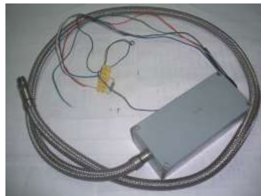
Рис. 3. Датчик давления Kistler 7613С
