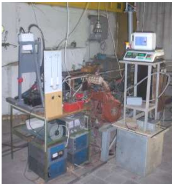
Рис. 2. Экспериментальная установка на базе двигателя с искровым зажиганием 2Ч 7,2/6
