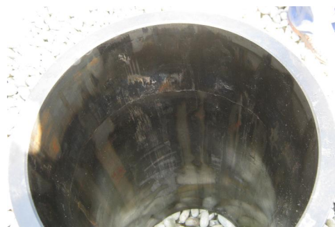
Рис.2. Задир рабочей поверхности гильзы рабочего цилиндра двигателя ЧН25/34
