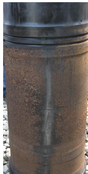
Рис.1. Гильза рабочего цилиндра двигателя ЧН25/34 с вертикальной трещиной
