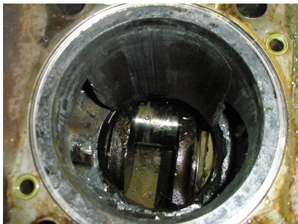
Рис.3. Задир рабочей поверхности и повреждения гильзы рабочего цилиндра газового двигателя Perkins 4016E-61NRC
