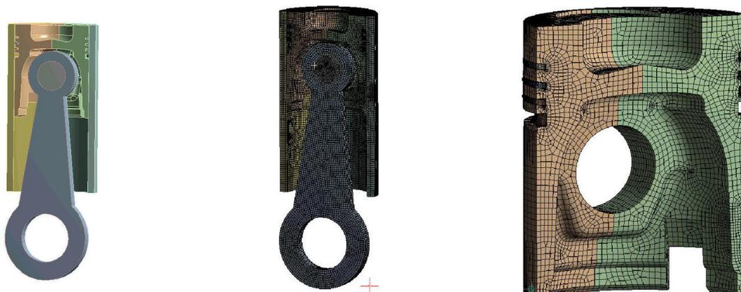
Полная геометрическая модель      Конечно-элементная модель      Конечно-элементная модель поршня
