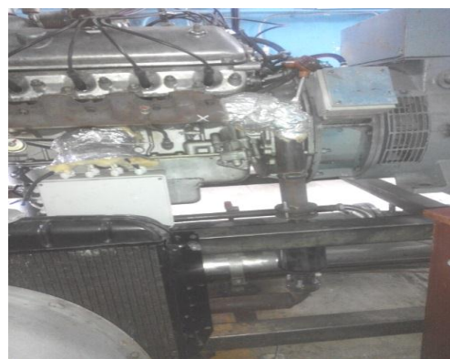
Рис. 5. Вид слева газовой установки с экспериментальным нейтрализатором
