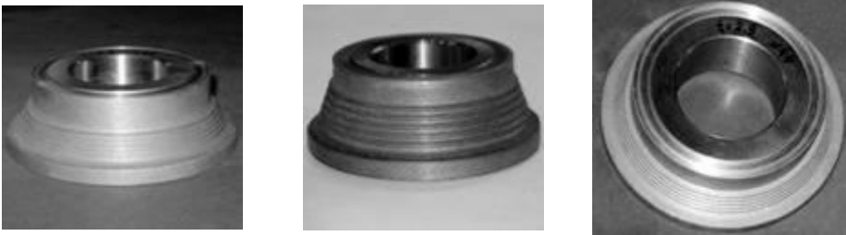
Рис. 1 – Прецизионные алмазные правящие ролики с елочным профилем для замочной части лопаток ГТД
