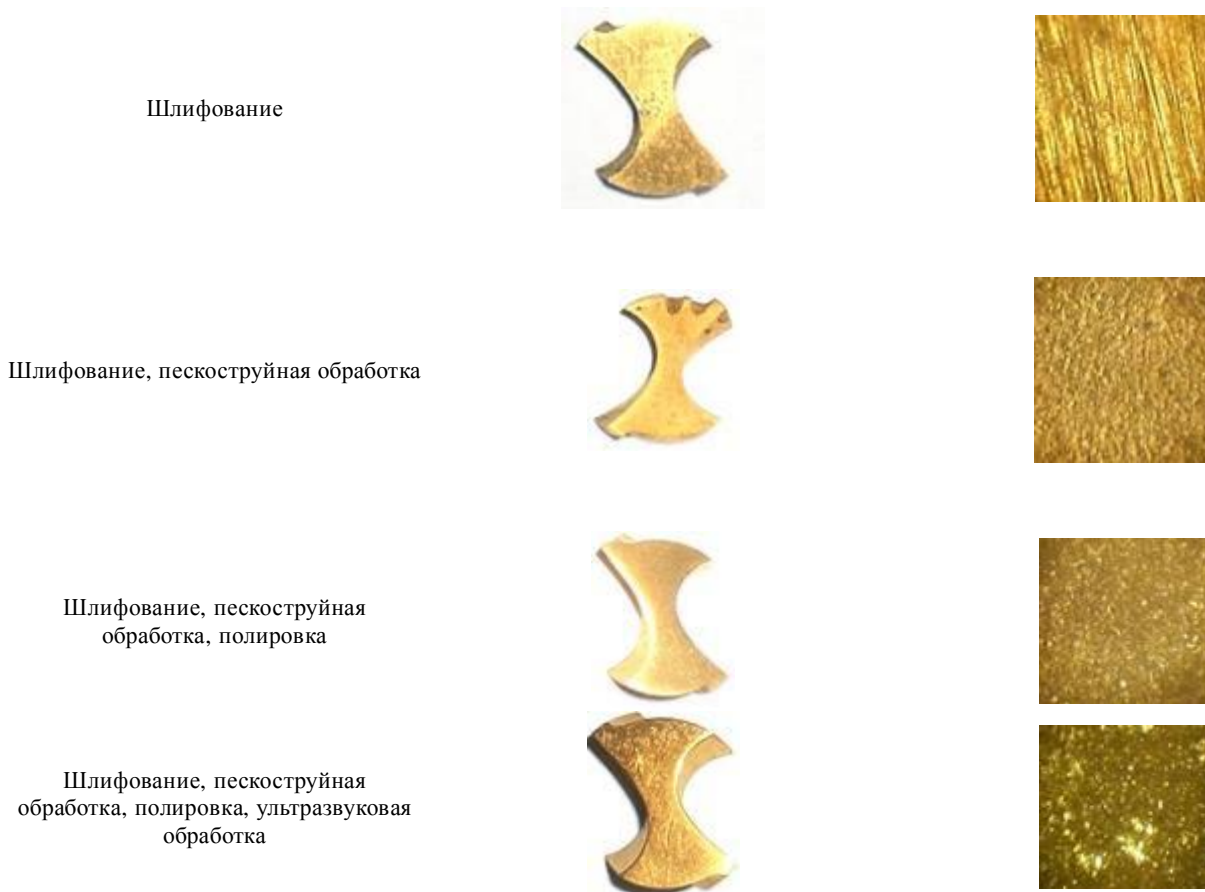
Рис. 1 – Поверхность образцов с вакуумными ионно-плазменными покрытиями, нанесенными после различных операций комбинированной отделочной обработки спиральных сверл (увеличение \times 50 )
