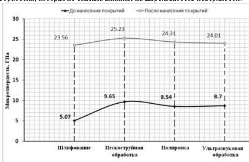
Рис. 4 – Влияние состояния поверхности и нанесения покрытий на микротвердость поверхности образцов по операциям отделочной обработки
