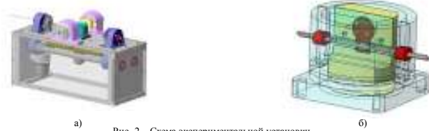
Рис. 2 – Схема экспериментальной установки а) – общий вид установки; б) – приспособление для установки и закрепления маятника.
