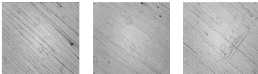
Рисунок 4 – Общий вид поверхности изделия из стали 18X2H4MA (увеличение  $\times 100$  раз): **а** - предварительное полирование, **б** – чистовое полирование, **в** - глянцеование
