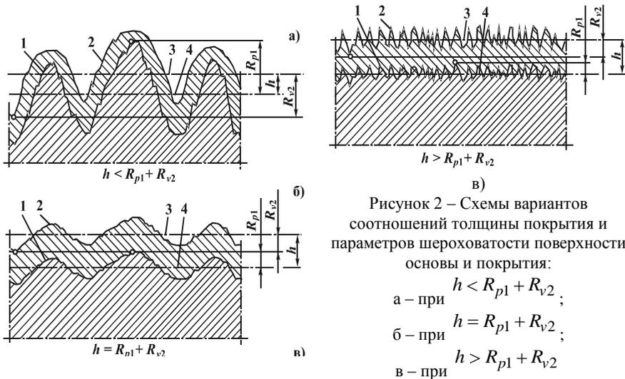
Рисунок 2 – Схемы вариантов соотношений толщины покрытия и параметров шероховатости поверхности основы и покрытия:
