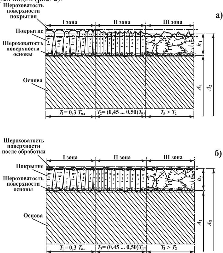
Рисунок 1 – Гипотетические модели вариантов параметров шероховатости поверхности основы и покрытия:
