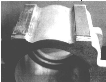
Рисунок 2 – Корпус буксы из алюминиевого сплава
