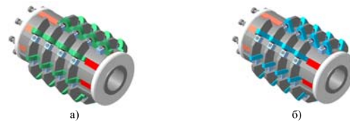
Рисунок 5 – Объемные модели червячных фрез для зацепления Новикова (а) и эвольвентного зацепления (б).
