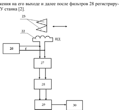
Рисунок 2 – Схема управления механизмом смены изношенного РИОР [2]
