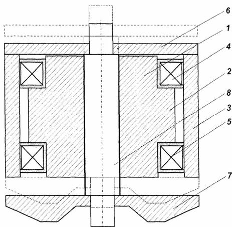
Рис. 2. Профильная проекция (осевое сечение) предлагаемого двухпозиционного электромагнита
