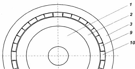
Рис. 3. Горизонтальная проекция (центральное сечение) предложенного двухпозиционного электромагнита
