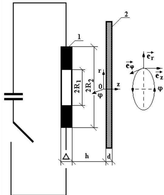
Рис. 1. Схема индукторной системы с одновитковым соленоидом (1) и плоской листовой заготовкой (2),
