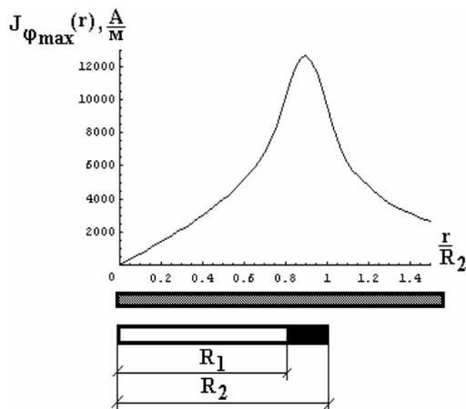
Рис. 4. Радиальное распределение тока в листовой заготовке в максимуме временной амплитуды (расчёт по формулам (25) и (26) в работе [2])
