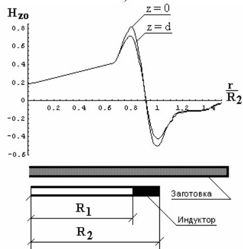
Рис. 2. Радиальные распределения нормальной (а) и радиальной (б) составляющих вектора напряжённости магнитного поля в тонкостенной листовой заготовке
