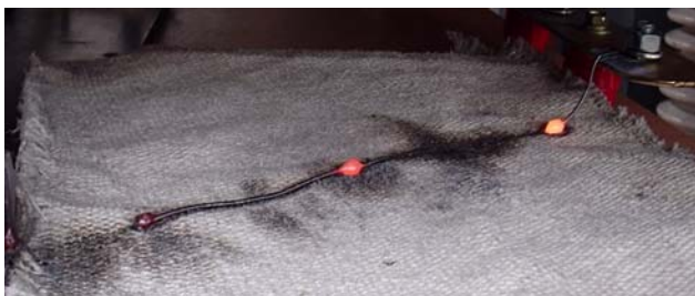
Рис. 8. Опытное распределение вдоль провода "горячих" (макроскопических зон ВЭП провода) и "холодных" продольных участков ( n \approx 4 )
