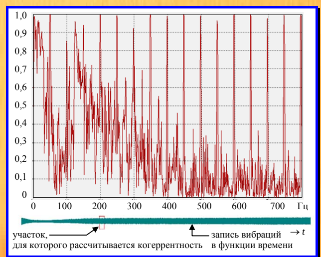
Рис. 3. Спектры (а) и когерентность (б) для установившегося режима (подшипник № 13)
