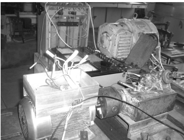
Рис. 4. Вентильный индукторно-реактивный двигатель, спаренный с делительной головкой
