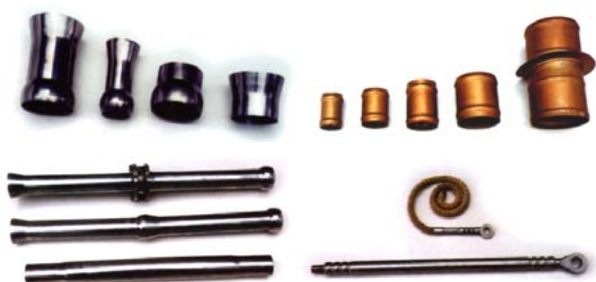
Рис. 10. Номенклатура деталей, изготавливаемых харьковскими политехниками с использованием энергии СИМП
