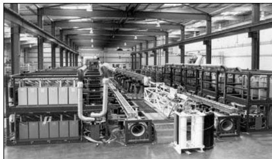
Рис. 7. Експериментальний багатосекційний рейкотронний прискорювач на енергію 32 МДж
