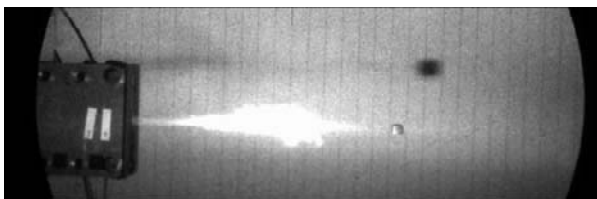
Рис. 4. Високошвидкісна фотозйомка вильоту якоря з плазмовим шлейфом з рейкотронного прискорювача
