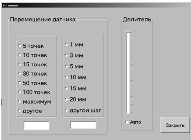
Рис. 2. Служебные установки дискретизации перемещения датчика и установки делителя входного сигнала
