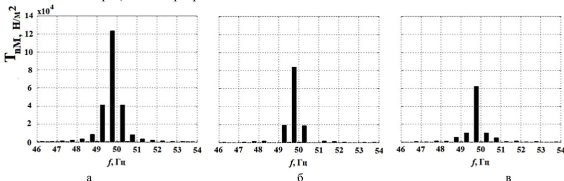
Рис 5. Спектрограммы АТД с двумя поврежденными стержнями в зоне оборотных гармоник: а – стержни расположены рядом в соседних пазах; б – стержни сдвинуты на  $45^\circ$ ; в – стержни сдвинуты на  $90^\circ$
