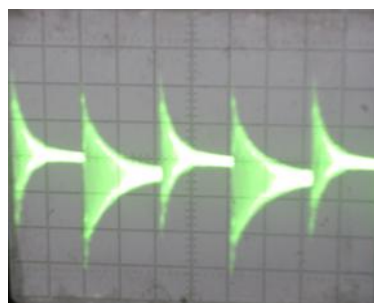
Рис. 6. Вид сигнала с выходных электродов пьезоэлемента № 3
