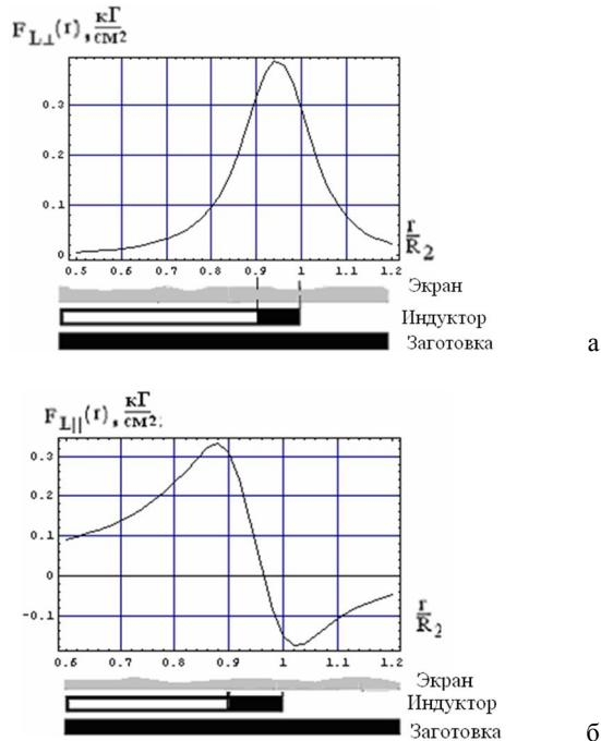
Рис. 5. Радиальные распределения компонент сил Лоренца в собственном временном максимуме для немагнитных металлов,  $\mu_r = 1$ , а) нормальная  $z$ -составляющая (отталкивания-притяжения), б) тангенциальная  $r$ -составляющая (растяжения-сжатия)
