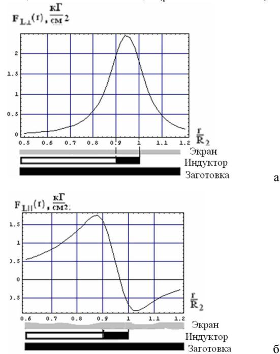
Рис. 6. Радиальные распределения компонент сил Лоренца в собственном временном максимуме для  $\mu_r = 2.5$ , а) нормальная  $z$ -составляющая (отталкивания-притяжения), б) тангенциальная  $r$ -составляющая (растяжения-сжатия)
