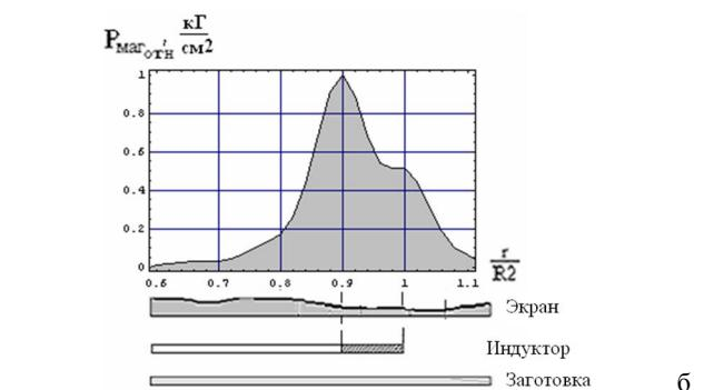
Рис. 8. Радиальная зависимость магнитной силы в металле заготовки в относительных единицах (нормировка производится на амплитудное значение) а)  $\mu_r = 1.5$  ( $0.9 \text{ кГ/см}^2$ ), б)  $\mu_r = 2.5$  ( $2.16 \text{ кГ/см}^2$ )
