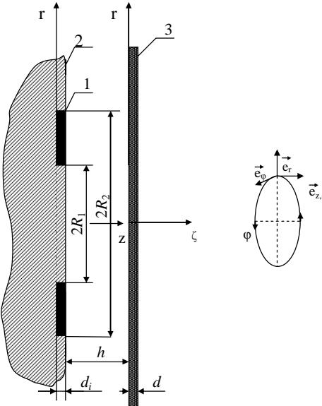
Рис. 1. Расчёчная модель индукционной индукторной системы
