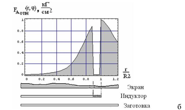
Рис. 7. Радиальное распределение силы притяжения – Ампера в собственном временном максимуме, а)  $\mu_r = 1.0$ ,  $F_{Amax,oth} = 38 \text{ кГ/см}^2$ , б)  $\mu_r = 2.5$ ,  $F_{Amax,oth} = 91.4 \text{ кГ/см}^2$
