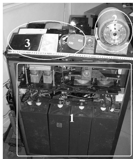
Рис. 1. Экспериментальный магнитно-импульсный комплекс: 1 – источник мощности (силовоточный генератор), 2 – индукторная система-инструмент, 3 – экспериментальные образцы
