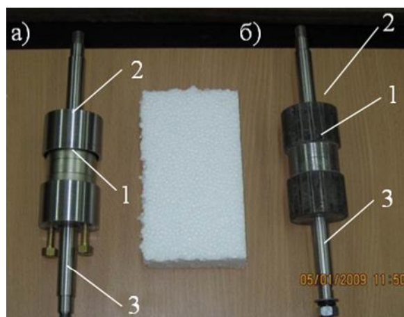
Рис. 1. Якорь вибровозбудителя КЛСД: а) КЛСД-ПМ-А; б) КЛСД-ПМ-Р
