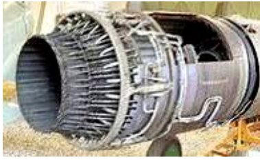
Рис. 22. Внешний вид регулируемого сопла советского форсированного турбореактивного двигателя типа АЛ-21 [23]
