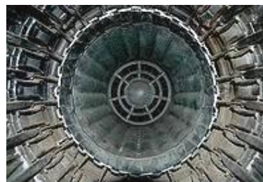
Рис. 21. Форсажная камера американского турбореактивного двигателя типа GEJ79 (вид со стороны сопла двигателя) производства компании "General Electric" (США) [23]
