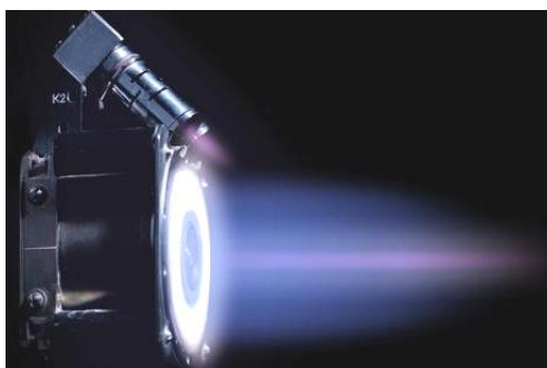
Рис. 30. Внешний вид реактивной плазменной струи при работе в вакууме плазменного ракетного двигателя [28]
