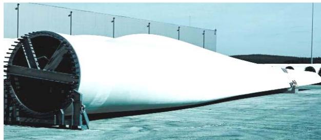
Рис. 8. Укрупненное изображение отдельной лопасти длиной 40 м современной горизонтально-осевой ВЭУ, размещенной на заводской площадке готовой продукции [2, 11]
