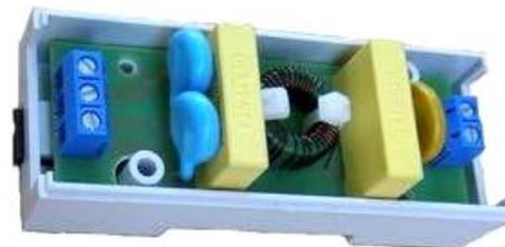
Рис. 20. Внешний вид ЕМІ-фильтра (с открытой пластмассовой крышкой изоляционного корпуса ФНЧ) для защиты от импульсных помех устройств автоматизации и управления (ток – 10 А; напряжение – 260 В; частота – 50/60 Гц) [47]
