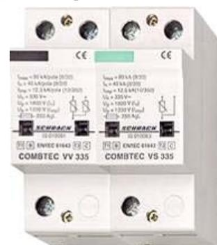
Рис. 8. Внешний вид мощных грозозащитных разрядников типа COMBTEC VV 335 и COMBTEC VS 335, коммутирующих импульсные токи 10/350 мкс молнии амплитудой до 40 кА и ограничивающих грозовые перенапряжения для электротехнического оборудования до уровня 1 кВ [35]
