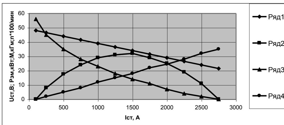
Рисунок – Стартерные рабочие характеристики стартера-генератора СГ-18-1С
