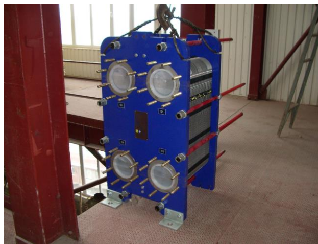
Рисунок 2 – Специальный паровой пластинчатый теплообменник TS20-MFM производства «Альфа Лаваль»
