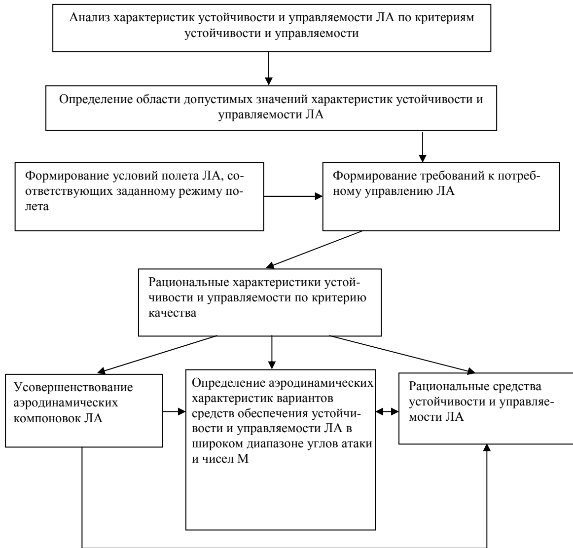
Рисунок 1 – Логико-структурная схема основных этапов синтеза средств обеспечения устойчивости и управляемости ЛА
