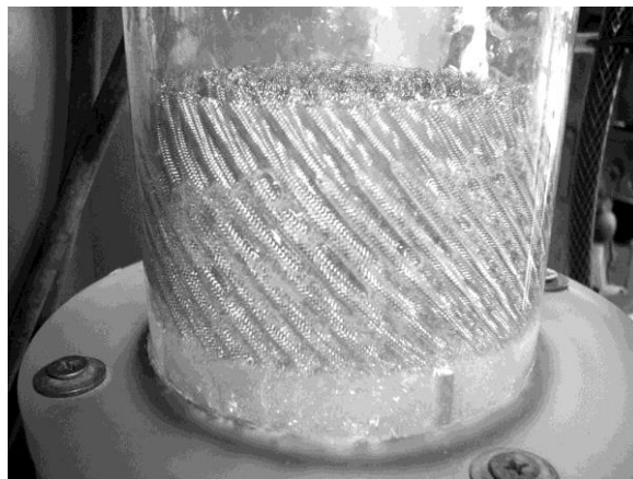
Рисунок 2 – Лабораторний стенд із сітчастими ґратами і стабілізатором пінного шару DYNAMIX, W_r = 0,5 м/с
