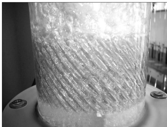
Рисунок 1 – Лабораторний стенд із сітчастими ґратами і стабілізатором пінного шару DYNAMIX, W_r = 1,7 м/с
