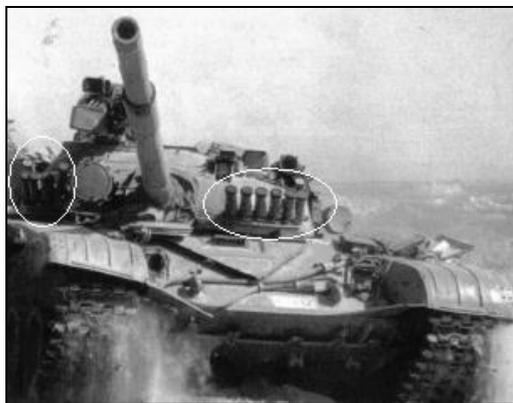
Рисунок 2 – Пусковые установки системы постановки завесы Т-72
