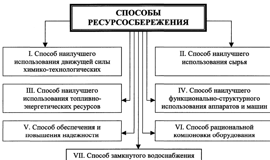
Рисунок 3 – Классификация физико-химических и инженерно-технологических способов обеспечения ресурсосбережения на химических, нефтехимических, нефтеперерабатывающих и биохимических предприятиях
