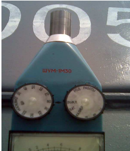
Рисунок 2 – Общий вид прибора Шум – 1М30
