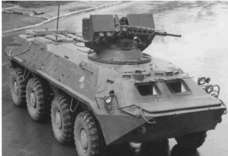
Рисунок 8 – Бронетранспортер БТР-70 с двигателем УТД-20
