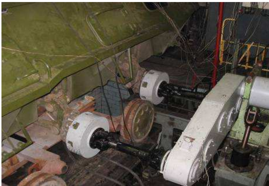
Рисунок 2 – Подключение суммирующего редуктора к ступицам колёс задних мостов бронетранспортера с помощью карданных валов и переходников
