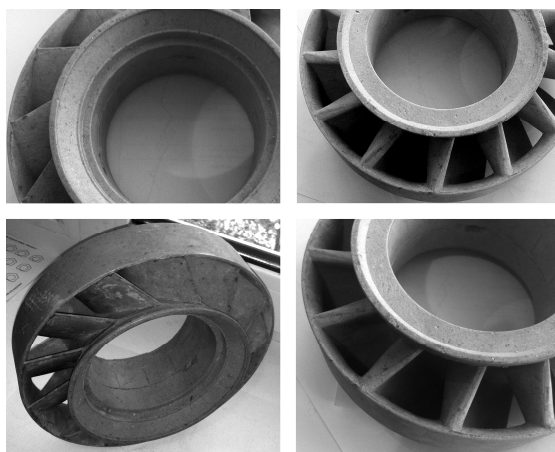
Рисунок 5 – Восковая модель колеса реактора, полученная на основе использования карбамидных стержней и предназначенная для получения пустотелой керамической литевой формы
