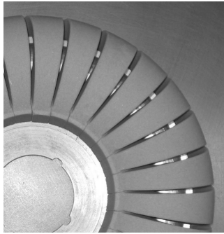
Рисунок 3 – Литевая форма насосного колеса, полученная с использованием отдельных наборных стержней
