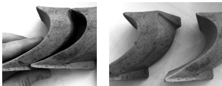
Рисунок 4 – Карбамидные стержни, предназначенные для получения восковой модели лопаточного колеса
