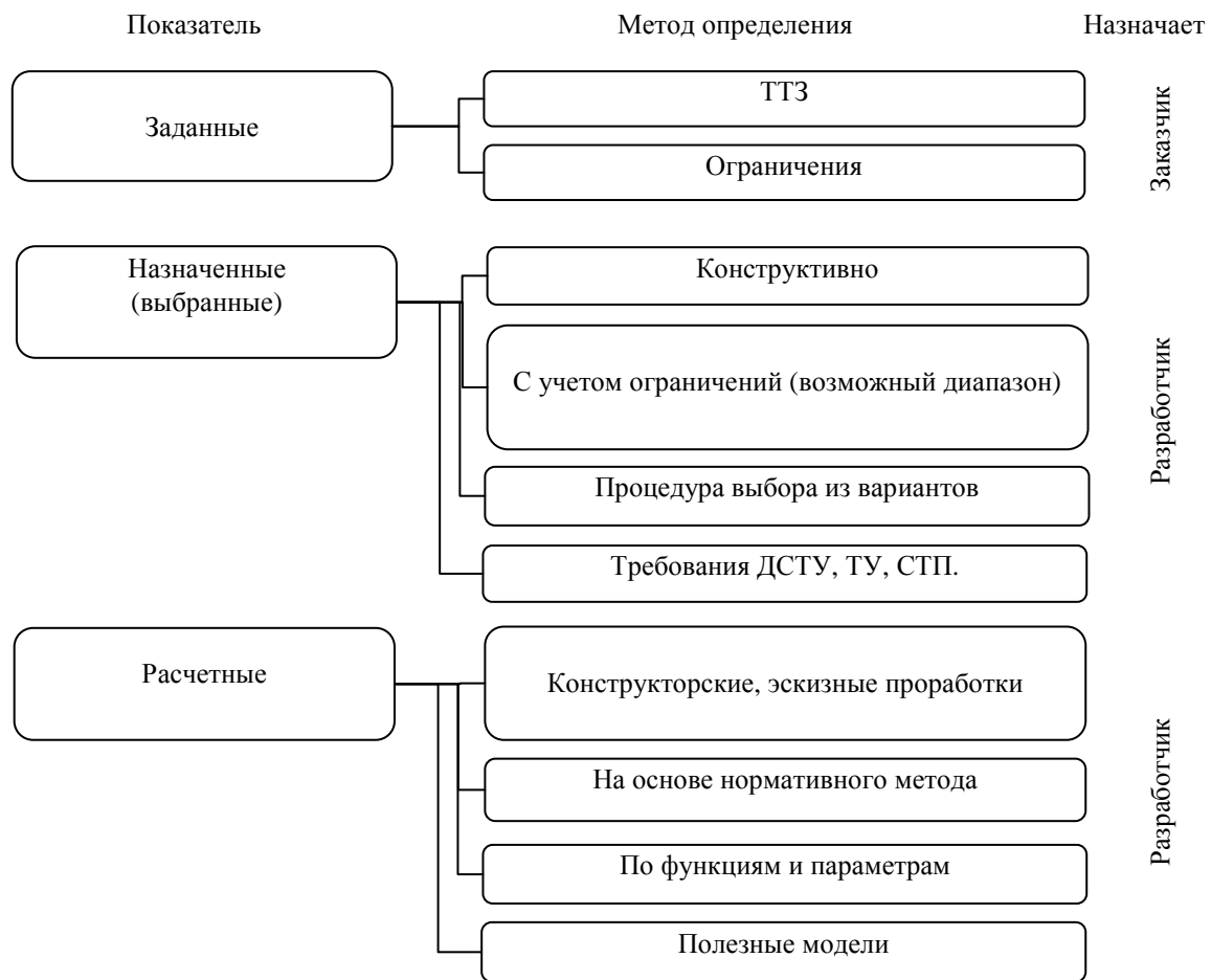
Рисунок 3 – Структура показателей PDM протокола
