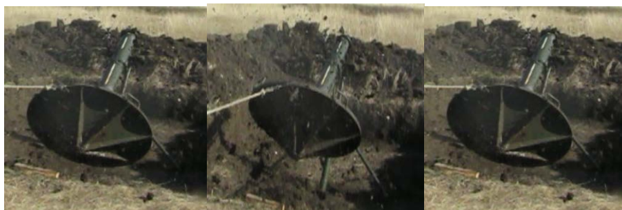
Рисунок 4 – Опрокидывание миномета при производстве выстрела
