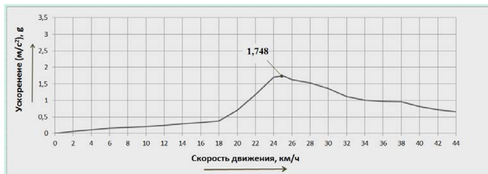
Рисунок 5 – СКО вертикальних ускорень на місці механіка-водителя/екипажа при русі изделия БТР-4 с управляемыми амортизаторами по стандартной трассе
