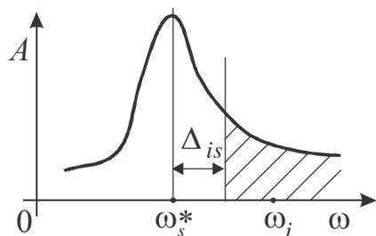
Рисунок 2 – К задаче отстройки от резонансных режимов
